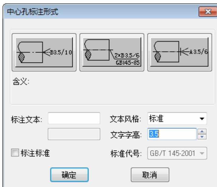
图 3-84 中心孔标注对话框
