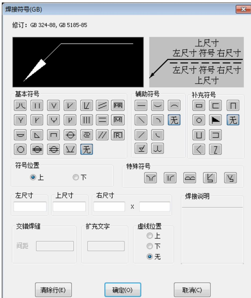
图 3-78 焊接符号对话框
