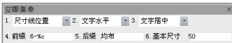
图 4-59 编辑直径尺寸或半径尺寸立即菜单
