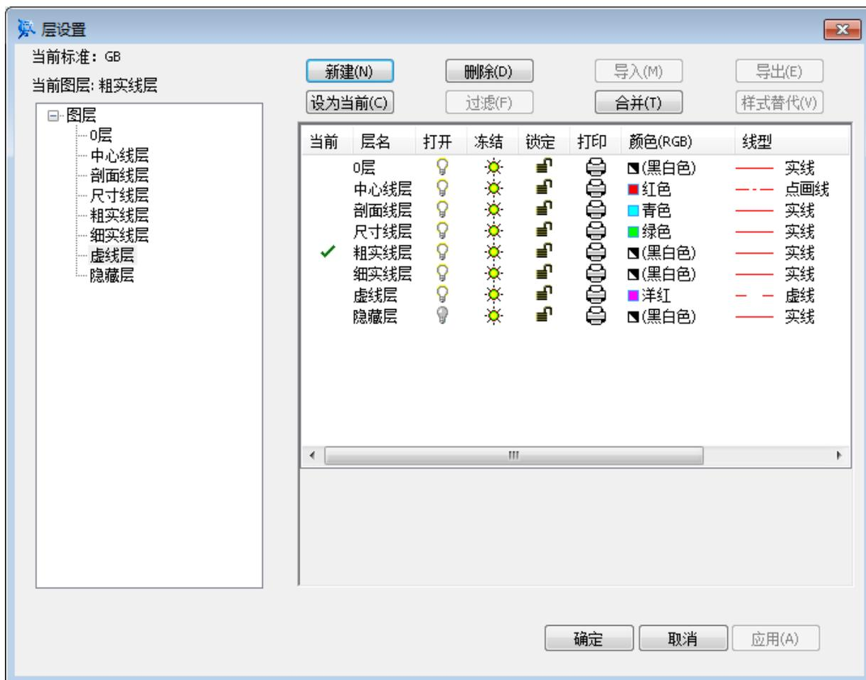
图 1-47 图层设置对话框
